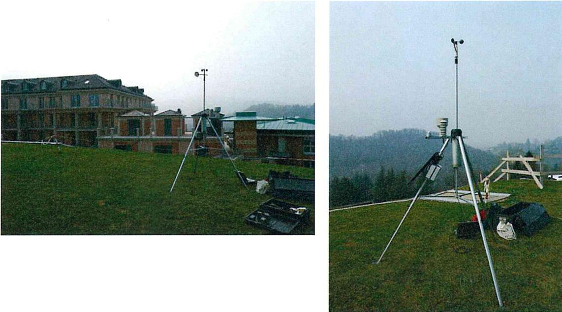
**Figura 12 – La stazione portatile MAWS installata presso le Ville Ottolenghi**
